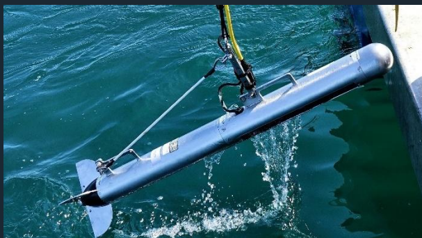
Fréquence 400/900 kHz Ouverture latérale de 12 à 150m
