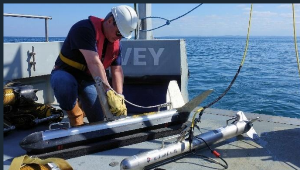
Gamme de Profondeur Jusqu'à 200 m Résolution à 400 kHz 0,023 m - 900 kHz 0,015m
